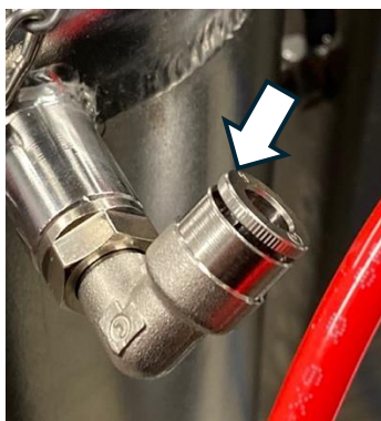
Tryck in och håll emot på brickan när du drar. För att återställa trycker man bara in slangen
