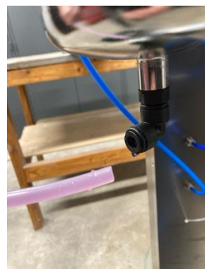
Lossas även slangen för likör i botten kan likörtanken tas loss helt och sköljas under kran
